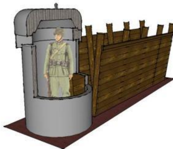
Afbeelding 23. 'Artist impression': doorsnede van het type Kochbunker met holle buis, tussenring en deksel (bron afbeelding en bewerking: L. van Midden).
